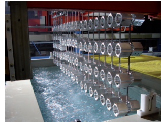
Aluminium-Bauteile auf einem Beschichtungsgestell
